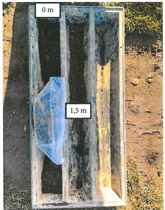
Geologický profil sondy S9
