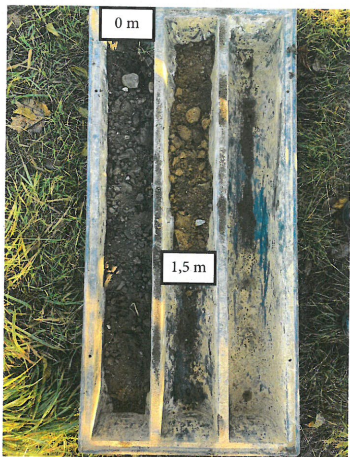
Geologický profil sondy S4
